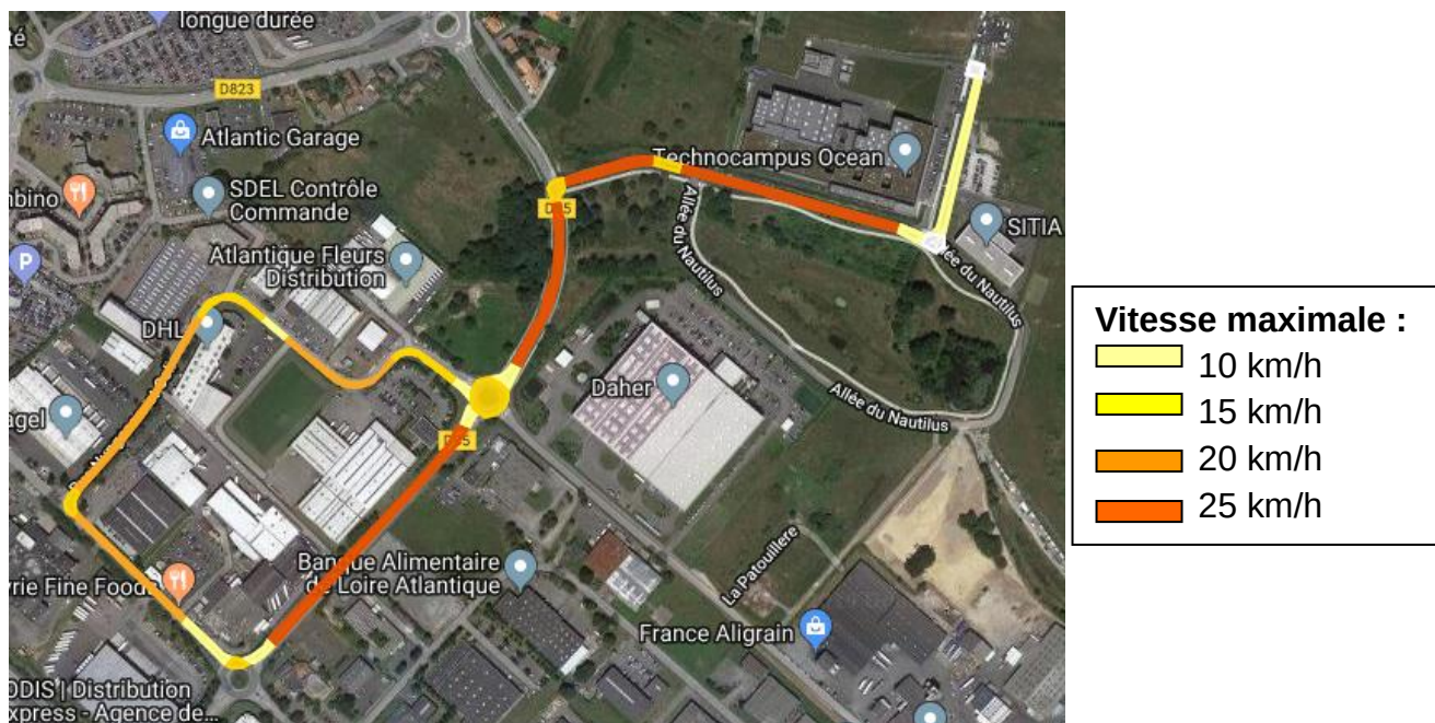
Figure 3: profils de vitesse de la navette autonome (Source: SEMITAN)
